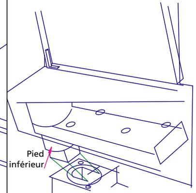
3- Ajuster l'axe de la penture supérieure à l'aide d'un tournevis, fixer alors la porte en place.
