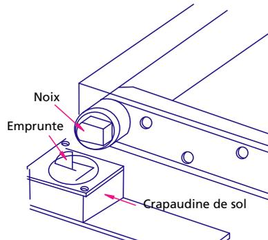
2- Faites pencher la porte de façon à pouvoir insérer entièrement le pied inférieur dans la crapaudine de sol. Levez alors la porte à la vertical.
