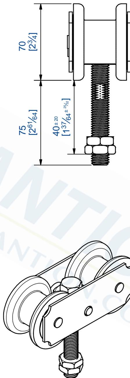
Monture pivotante avec 2 galets acier montés sur cage à rouleaux.
