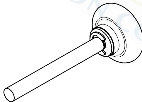
Galet nylon monté sur cage à rouleaux.
