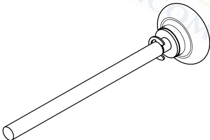
Galet nylon monté sur cage à rouleaux.
