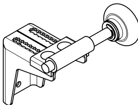
Monture avec galets Delrin monté sur equerre réglable
