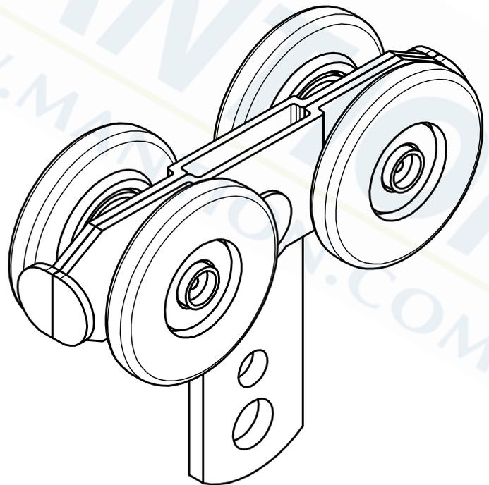
Monture à galets auto-orientables en acier montés avec roulements sur billes
