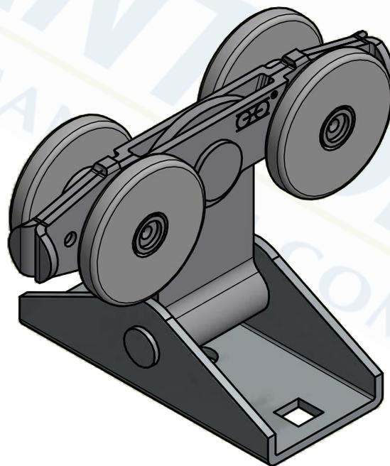
Chariot support de boîte équipé de galets Nylon montés sur roulements à billes.
