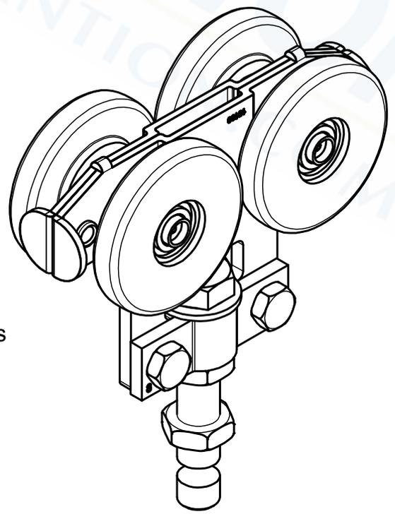
Monture avec support col de cygne, 4 roulements à billes avec un surmoulage en nylon chargé fibre de verre
