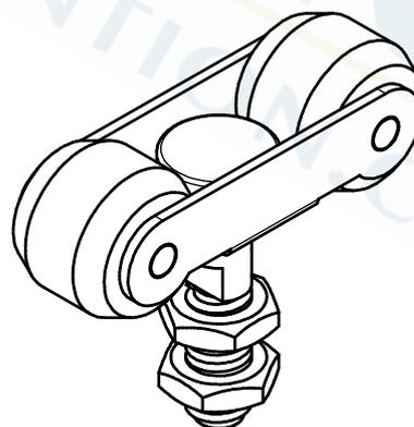
Monture pivotante avec 2 galets nylon montés sur cage à rouleaux.
