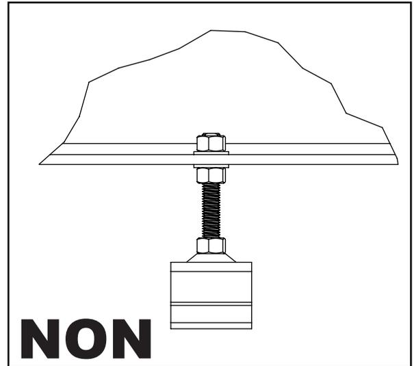
Pour le montage de ces éléments de fixation réglables, il faut prévoir un montage vers le milieu de la hauteur de la tige filetée. Ne je jamais faire un montage en haut de tige filetée.
